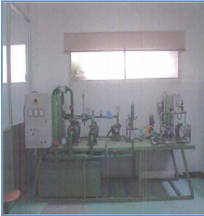
Banco de Bombas Hidráulicas
